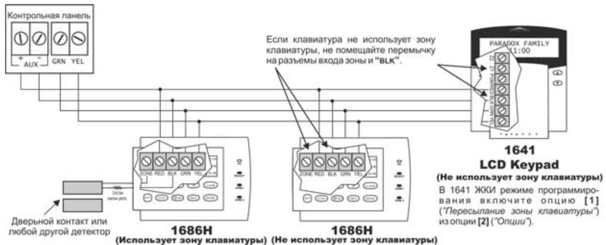
Рис. 2.7: Подключение к зоне клавиатуры
